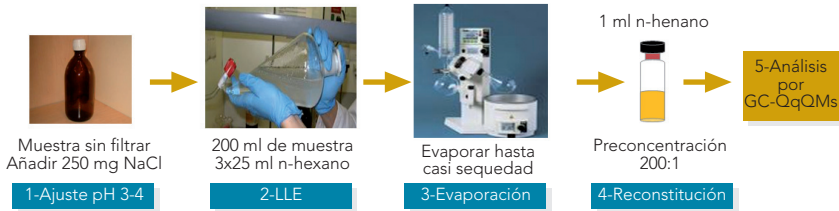
Figura 5. Esquema del procedimiento de extracción líquido-líquido previo análisis del multiresudio de sustancias prioritarias por GC-MS/MS.
