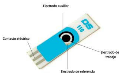
Fig.2 Electrodo serigrafiado con tres electrodos.
